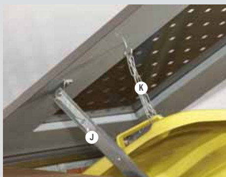
Variante mit Klappdeckel: Einhandbedienung durch Teleskopaufsteller (J) (hält den Deckel offen), Zugkette (K) öffnet den Tonnendeckel „automatisch“.
